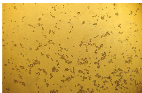
شکل-۴ اثر افزایش pH از ۲ به ۴ بر روی نانوذره تولید شده (A۹). همانطور که شکل میکروسکوپ نوری از این نانوذره نشان می دهد برخی اشکال کریستالی پلیمر در این pH تشکیل می شود (بزرگنمایی ۱۰۰ ×)
