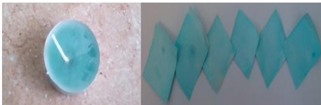
شکل ۵. کاغذها و شمع رنگ آمیزی شده با پیگمان پیوسیانین
