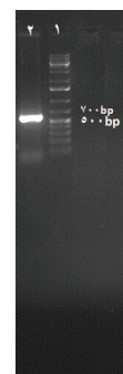
شکل ۲. ژل الکتروفورز قطعه حد واسط اول، جدا شده توسط PCR بطول ۶۰۰bp
