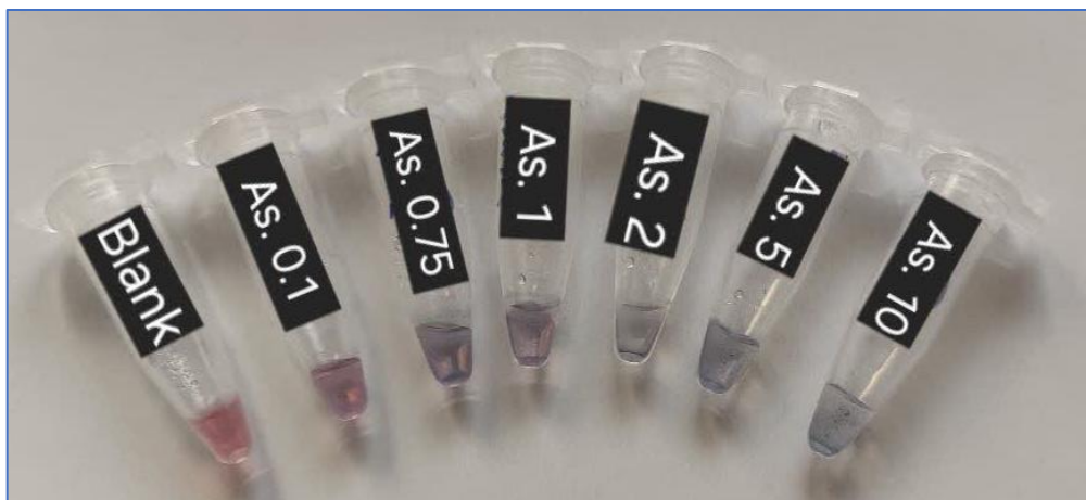
شکل ۱- بررسی نتایج آزمون حساسیت آپتاسنسور ویژه آرسنیک به صورت کیفی.
