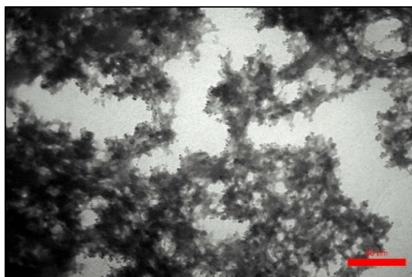
شکل ۳- الف و ب. تصاویر (SEM) نانوفتوکاتالیست CQDs/ZnO/TiO 2 در دو بزرگ‌نمایی مختلف
