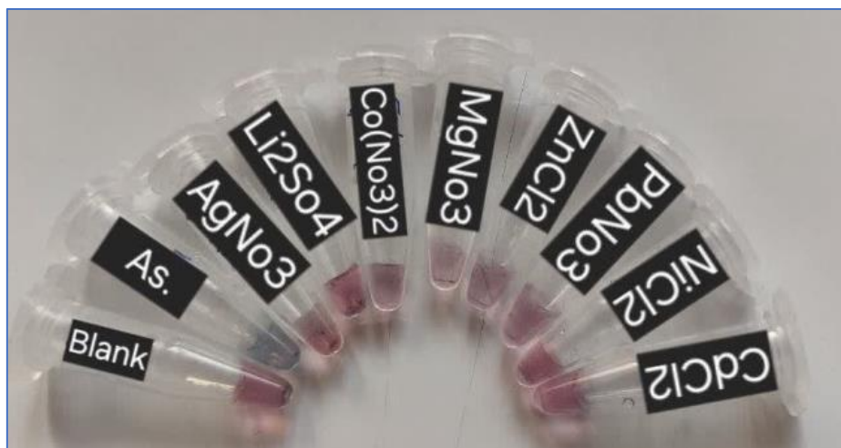
شکل ۳- بررسی نتایج آزمون گزینش پذیری اپتاسنسور ویژه آرسنیک به صورت کیفی.
