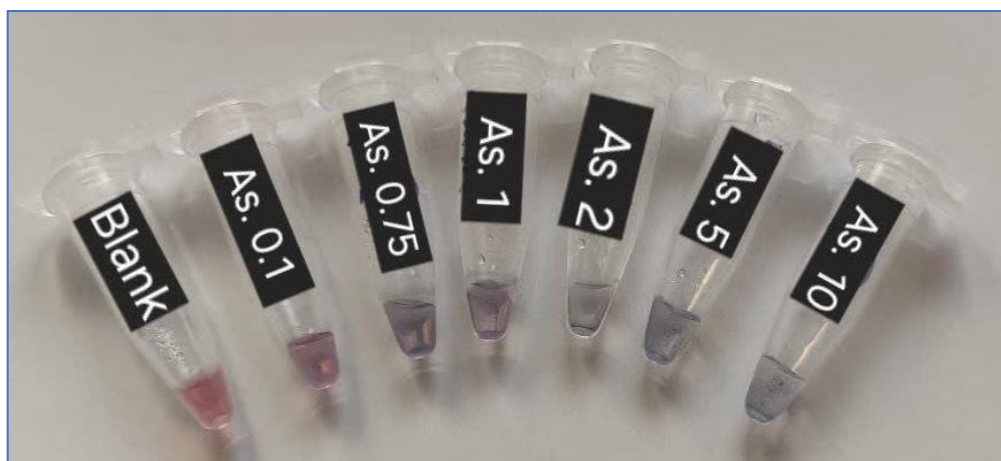
شکل ۱- بررسی نتایج آزمون حساسیت آپتاسنسور ویژه آرسنیک به صورت کیفی.
